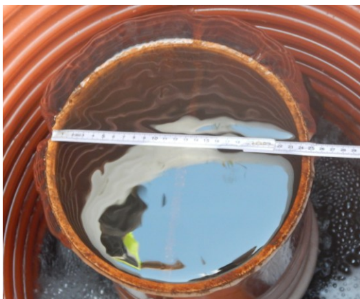
Figur 7.15 Eksempel på måling af diameter på et udløbsrør i en iltbrønd.
