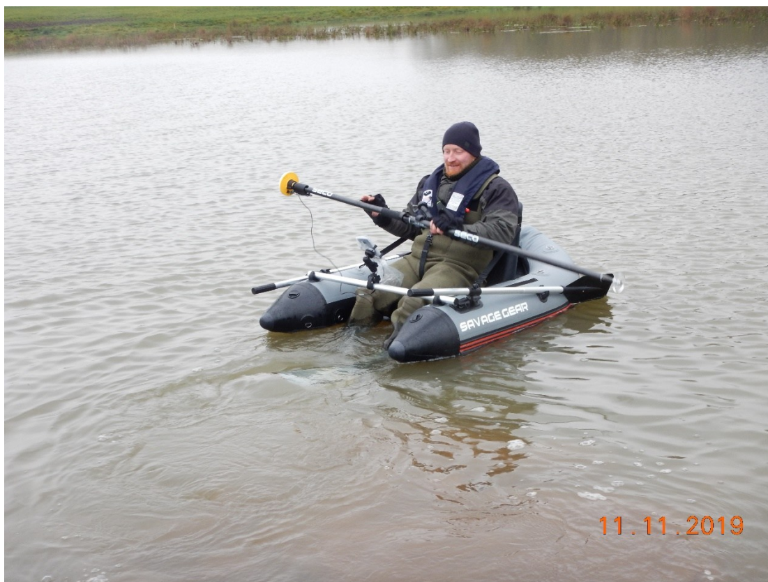
Figur 6.1 Der anvendes flydering til opmåling
